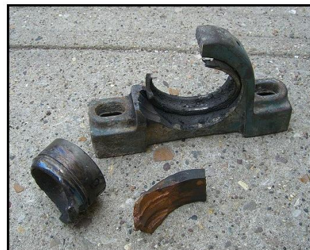
esempio di cedimento del cuscinetto
