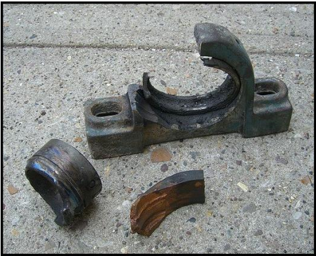
esempio di cedimento del cuscinetto
